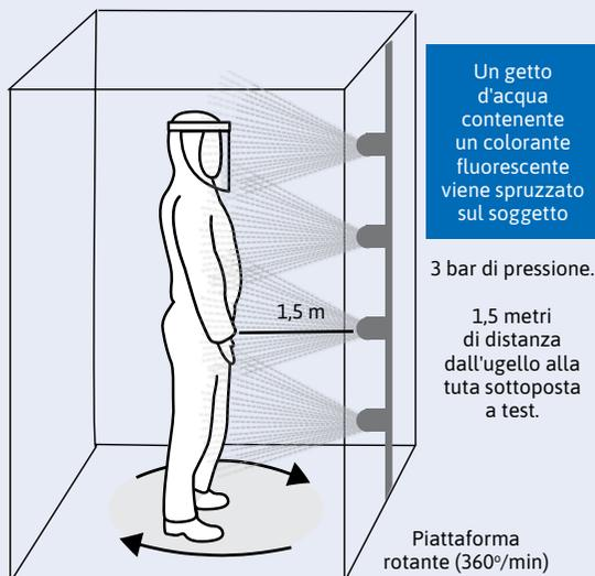
Il soggetto sottoposto a test cammina in modo esageratamente lento, sollevando braccia e gambe durante il test per esporre allo spruzzo tutte le parti della tuta.
