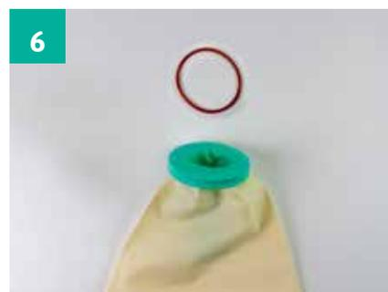
6 重复图5所示动作，确保手套袖口完全覆盖接头
