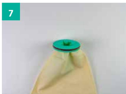
7 将硅橡胶O形环固定至手套接头凹槽
