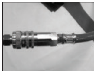
Conexión de la manguera al ERA
