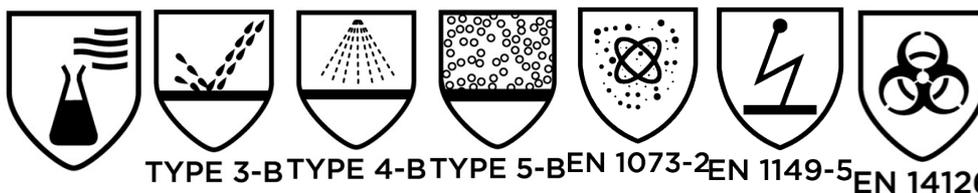
erfüllt die Vorschriften der Verordnung (EU) 2016/425 und der Normen , EN 14605:2005 + A1:2009, EN ISO 13982-1:2004 + A1:2010, EN 1073-2:2002, EN 1149-5:2008, EN 14126:2003 (ausgenommen eines nicht durchgeführten Entflammbarkeitstests), und ist identisch mit der PSA, die der EU-Baumusterprüfung (Modul B, Anhang V der Verordnung) unterliegt; die von der benannten Stelle zugewiesene Zulassungsnummer GB18/961840.00 lautet:
