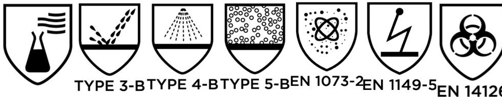
erfüllt die Vorschriften der Verordnung (EU) 2016/425 und der Normen , EN 14605:2005 + A1:2009, EN ISO 13982-1:2004 + A1:2010, EN 1073-2:2002, EN 1149-5:2008, EN 14126:2003 (ausgenommen eines nicht durchgeführten Entflammbarkeitstests), und ist identisch mit der PSA, die der EU-Baumusterprüfung (Modul B, Anhang V der Verordnung) unterliegt; die von der benannten Stelle zugewiesene Zulassungsnummer GB18/961840.00 lautet:
